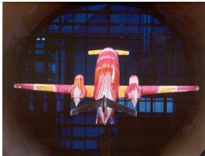
Prove di visualizzazione del flusso con vernici oleose su un modello del P.180 nella galleria di Finale (Foto Piaggio)
